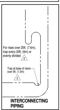
FACTORY REFRIGERANT PIPING FIELD PIPING
