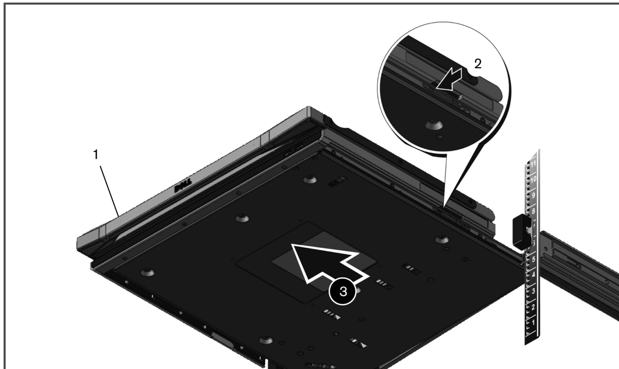
Abbildung 4.1 Entfernen des Konsolen-Trays aus dem Rack
