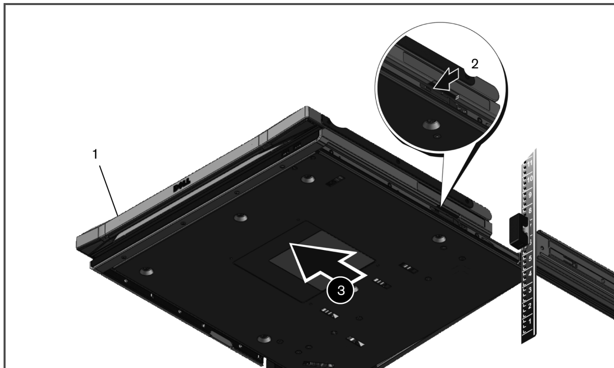
Gambar 4.1 Melepas Baki Konsol Dari Rak
