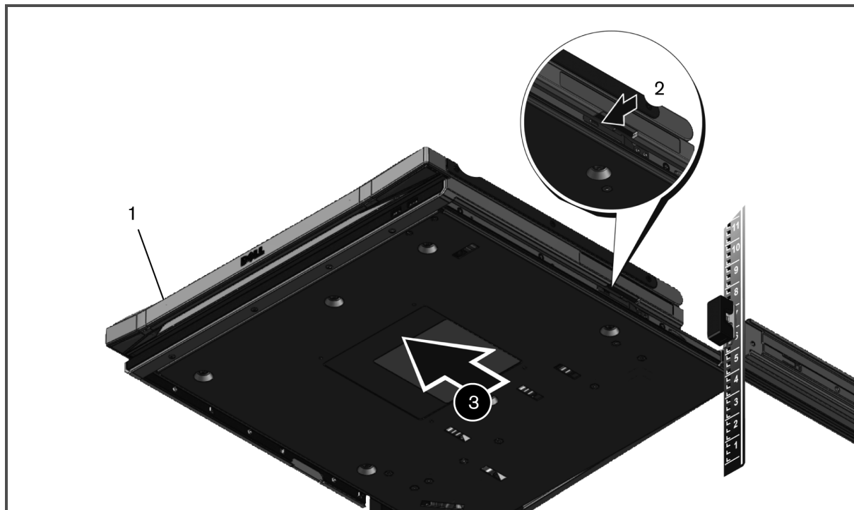
圖 4.1 從機架拆除主控台托盤
